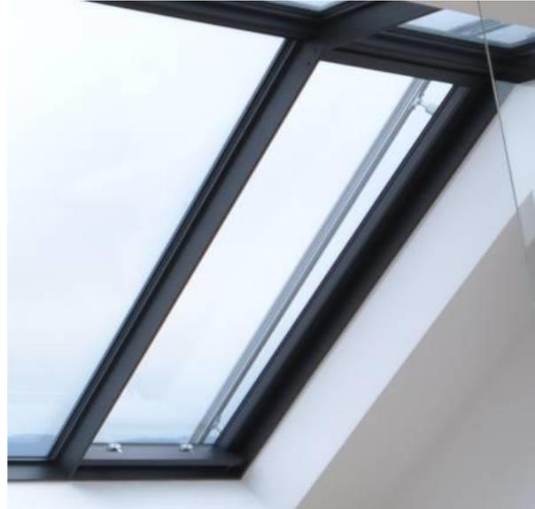
Der **wing S** ist das kleinste Mitglied der Wing-Familie mit Abmessungen bis  $2\text{m}^2$  und einem maximalen Flügelgewicht von ca. 100 kg. Die Öffnung erfolgt mittels eines sichtbaren, untenliegenden Kettenschubmotors (optional mit Abdeckung in Profillfarbe). Die Öffnungshöhe ist je nach Flügelgröße ca. 400mm bis 600mm und alle Dachneigungen sind realisierbar.
